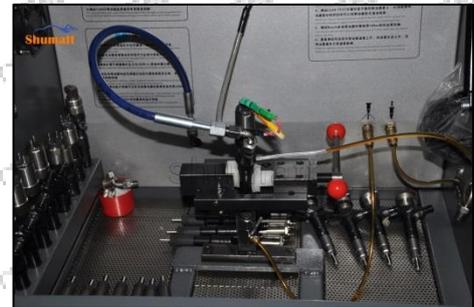
▲ عند الاختبار، يجب اختيار نموذج الحاقن الصحيح للاختبار
